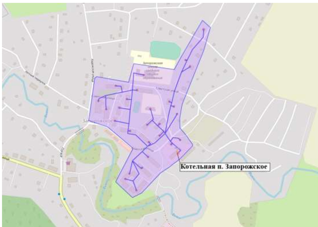
Рисунок 15.1 Зона действия котельной пос. Запорожское
