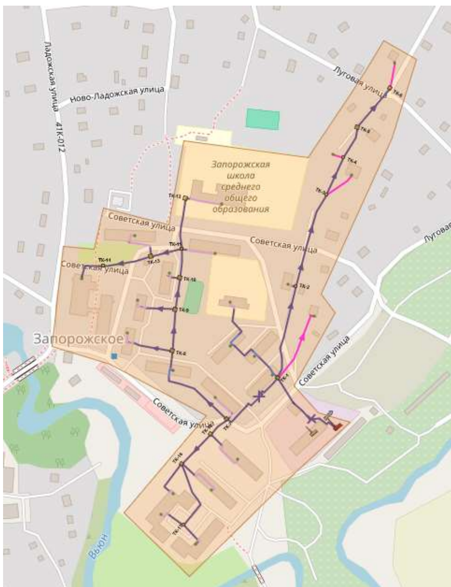
Рисунок 1.28 Зона действия котельной пос. Запорожское
