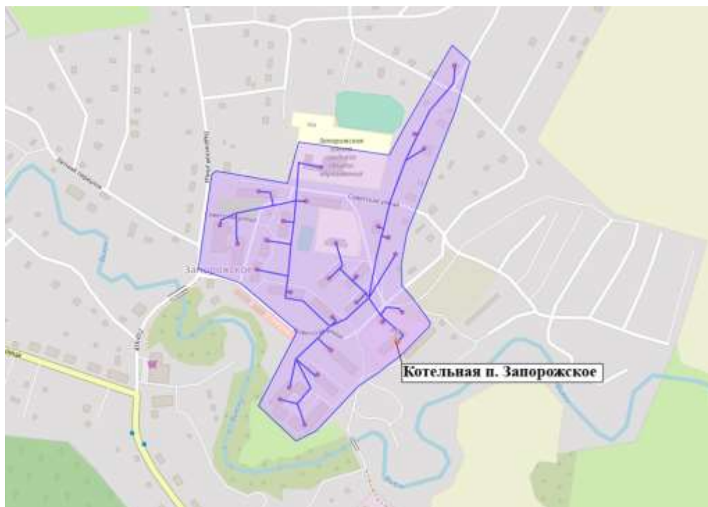
Рисунок 10.3 Зона действия котельной пос. Запорожское (зона теплоснабжения 001, концессионное соглашение)
