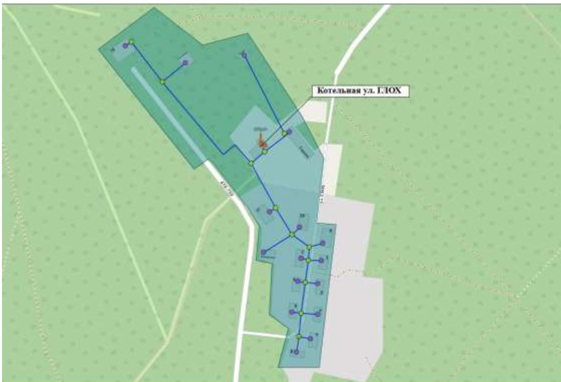
Рисунок 2.2 Зона действия котельной ГЛОХ
