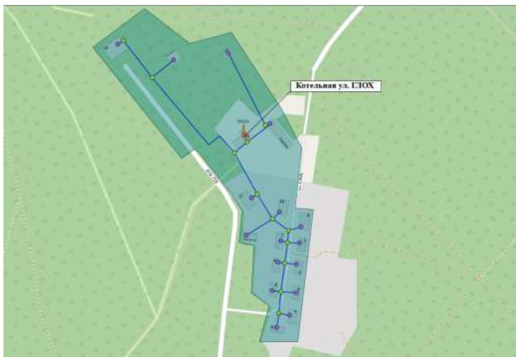
Рисунок 10.2 Зона действия котельной ГЛОХ (зона теплоснабжения 002)
