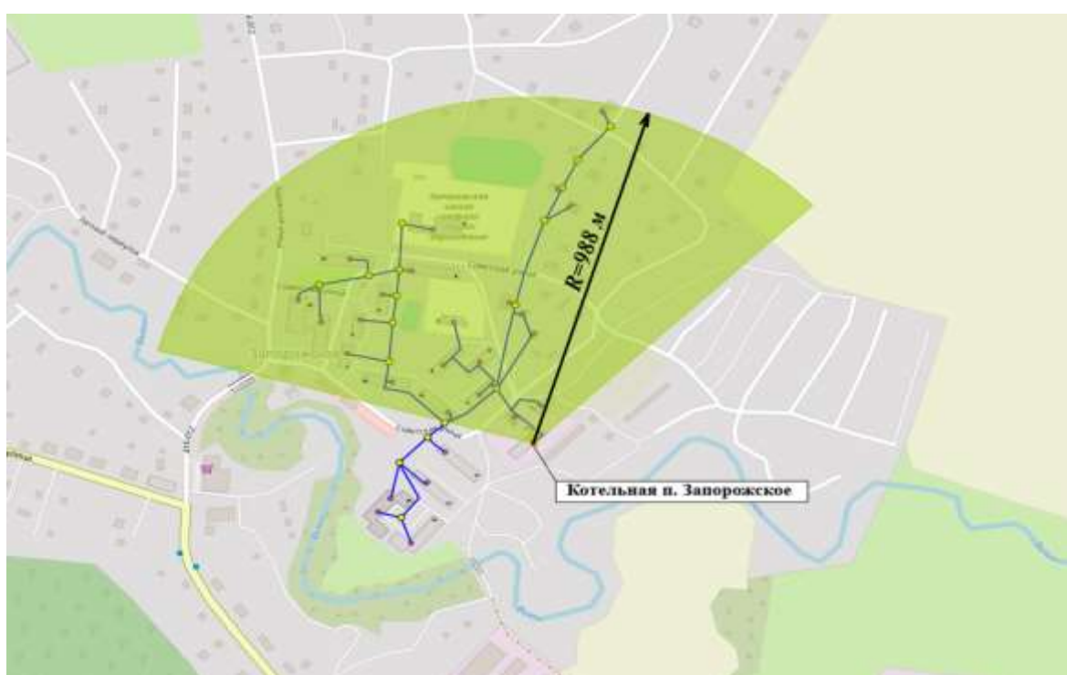
Рисунок 2.3 Тепловая зона и радиус эффективного теплоснабжения котельной пос. Запорожское
