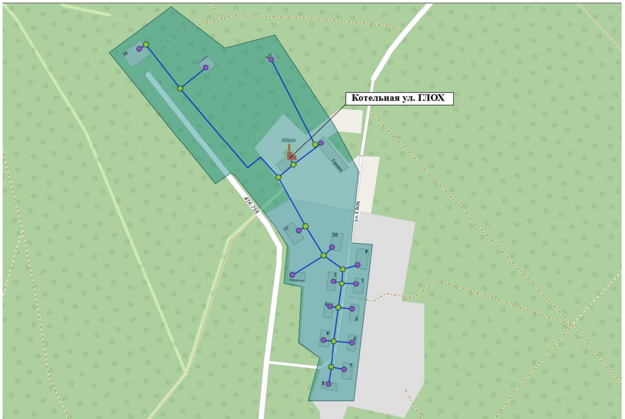
Рисунок 12 Зона действия котельной ГЛОХ
